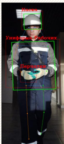
Контроль и анализ ношения обязательных СИЗ (Зимняя Униформа Рабочих, Очки, Каска, Перчатки, Минифильтр, Респиратор, страховочная привязь)
